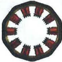
Figura 6.6. Sección en alzado de un estator.
